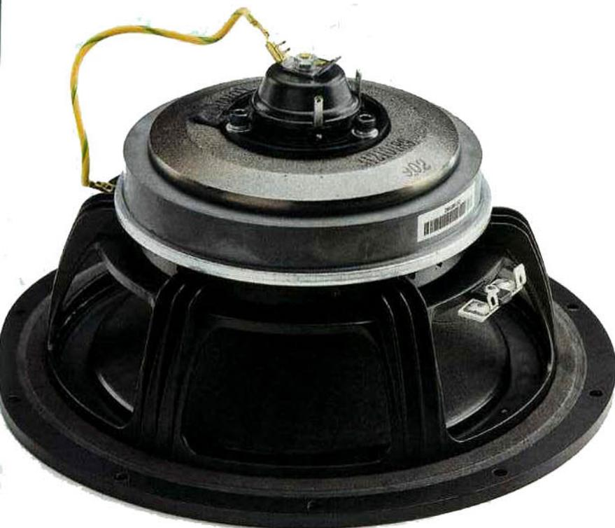
*Bellissimo e molto aperto il cestello del woofer di cui si evidenziano le razze d'irrigidimento e i fori di raffreddamento e decompressione della zona sottostante il centratore, anch'esso forato per lo stesso motivo. Il cavetto gialloverde serve alla messa a terra delle parti metalliche degli altoparlanti. La piastra polare posteriore del woofer è una bellissima realizzazione che alloggia anche il tweeter ben visibile alla sua sommità.*
